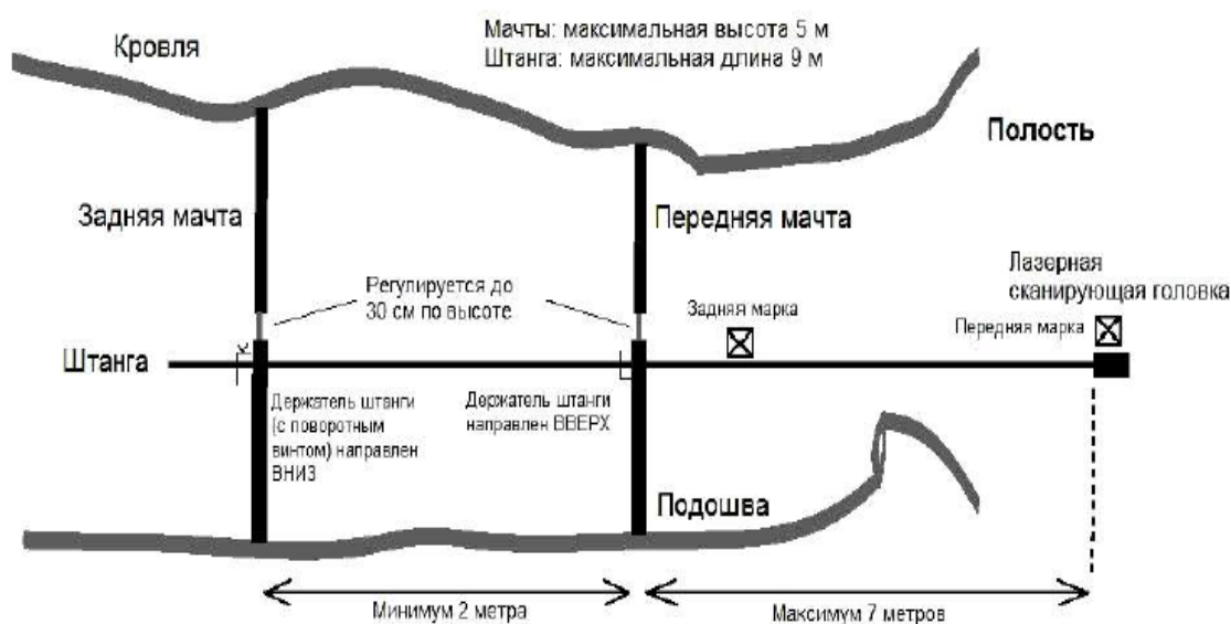
Рисунок 3.3 – Установка. Ввод сканера в полость
